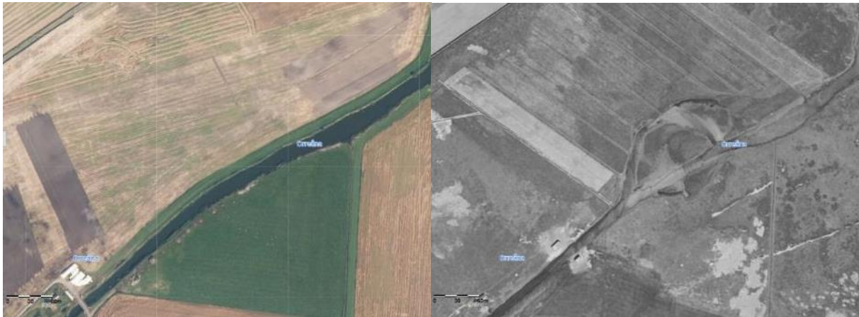
Figur 17. Orreåna er blitt utsatt for en rekke ulike inngrep. Flybildene viser todelt løp i 1953 helt øverst i elva (høyre), og dagens situasjon til venstre. Denne delen av elva er tidligere innsjøbunn. Lignende endringer er gjennomført i nedre del av løpet. Det er trolig gjennomført senkning av elvebunn flere steder. Kilde: Norge i bilder.
