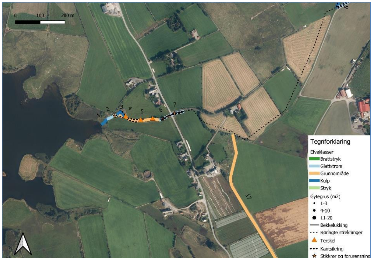
Figur 25. Elveklasser, gytegrus, lukkede og lange rørlagte bekkestreknings, terskler, erosjonssikrede kanter samt stikkør/mulige forurensningskilder. Nedre åpne del av Skådeheikanalen og Vådelandskanalen (17). Verdalskanalen (rørlagt) kommer inn litt oppstrøms punktet der 17 kommer inn (ikke markert).
