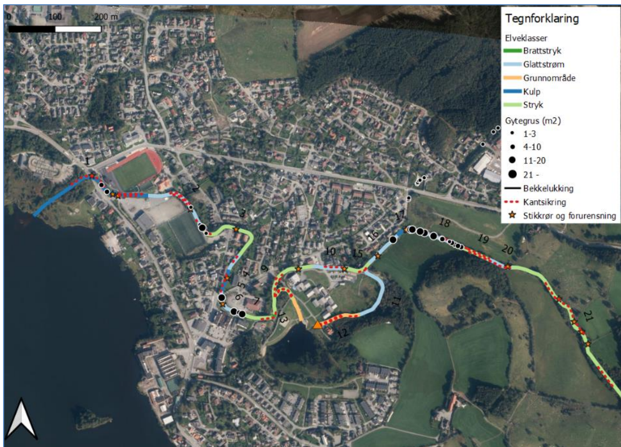
Figur 69. Elveklasser, gytegrus, kantsikring og stikkør/mulig forurensning i nedre del av Frøylandsbekken inkludert området ved Stemmen. Ved innløpet til Stemmen er det en terskel. Bekkeniøye ble observert i sone 16.
