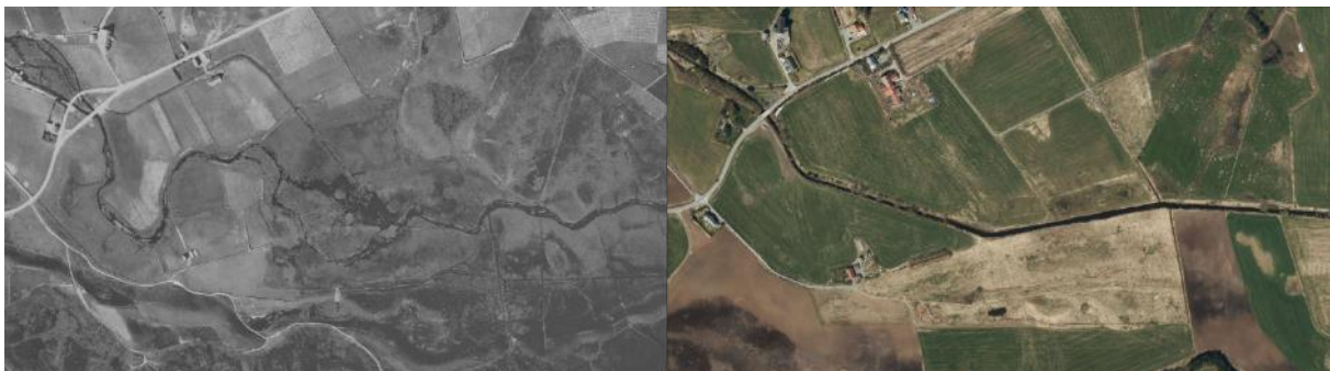
Figur 38. Til venstre sees del av Roslandsåna i 1937, mens høyre bilde viser situasjonen etter omfattende kanalisering, erosjonssikring og senkning. Kilde: Norge i Bilder.
